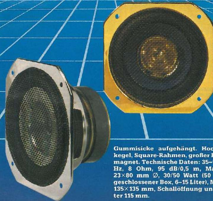
Gummisicke aufgehängt. Hochtonkegel, Square-Rahmen, großer Ferritmagnet. Technische Daten: 35–19000 Hz, 8 Ohm, 95 dB/0,5 m, Magnet 23×80 mm Ø, 30/50 Watt (50 W in geschlossener Box, 6–15 Liter), Maße: 135×135 mm, Schallöffnung und Gitter 115 mm.
