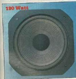
Mit Schaumstoffsicke und versteifter Membran, hochfeste Verklebungen, Spulenzuführung aus flexibler Spezial-Litze, geeignet für geschlossene Gehäuse und Baßreflex-Systeme. Nenn-/Sinusbelastg. nach DIN: 120 W in geschl. 60-Ltr.-Gehäuse. Musikbel.: 150-180 W, 8 Ohm, 28-2000 Hz, Reson.: 30 Hz, Alu-Schwingspule 48 mm Ø, Magnet 120 mm Ø, Korb-Ø 272 mm, Front mit Schaumstoffdichtung 307 mm Ø.
